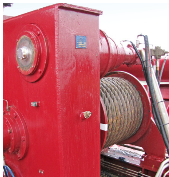
Drei dieser Winden richten das Saugrohr des Hopperbaggers aus, die Drehung der Welle erfasst der QR24
