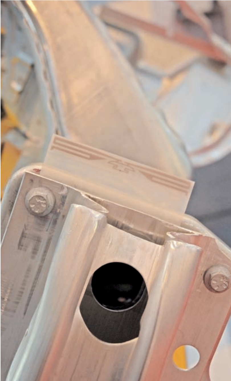
Bei Volvo in Gent wird ein robuster Kunststoff-Tag gleich zu Beginn des Rohbaus mit dem Längsträger der Karosserie verschraubt
